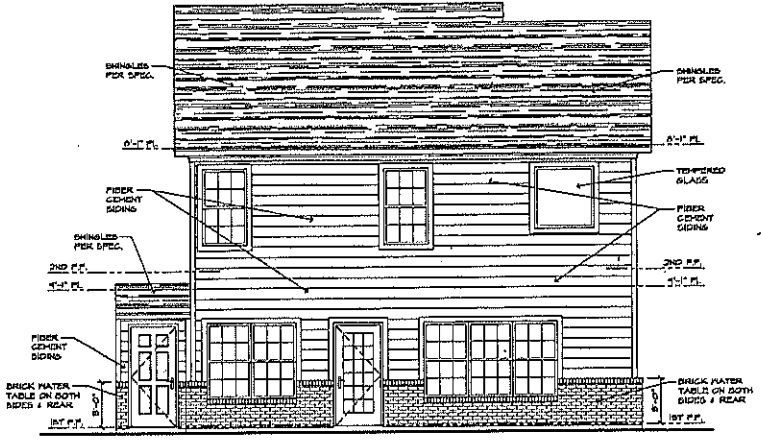
2 REAR ELEVATION - PITTMAN A1 SCALE: 1/8" = 1'-0"
